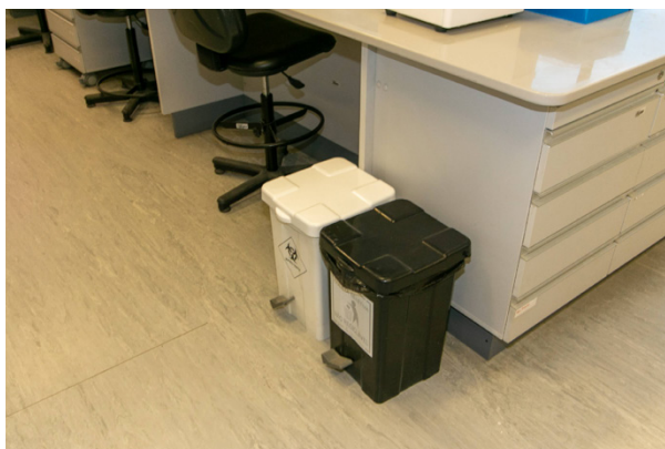
Figura 23 – Lixeiras com acionamento automático para resíduos do tipo A (branco) e resíduos do tipo D (preto) num laboratório de pesquisa em saúde
