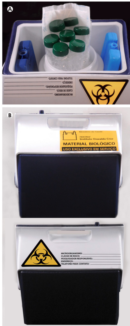
Figura 38 – Exemplo de acondicionamento e sinalização de transporte de material biológico entre laboratórios de uma mesma instituição
