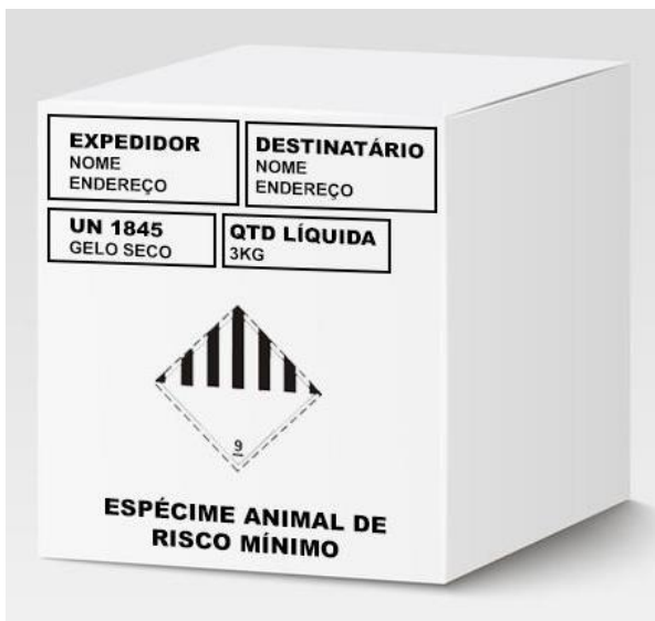
Figura 12: Marcação e etiquetagem de volume contendo Espécime Animal de Risco Mínimo e gelo seco
